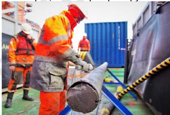
Рисунок 34 – Процесс отбора проб грунта
