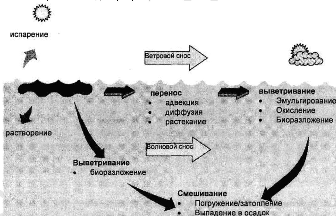
Рисунок 35 – Поведение дизельного топлива на воде.
