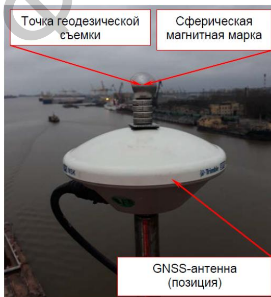
Рисунок 4.2 – Точка геодезической съемки на корпусе GNSS-антенны
