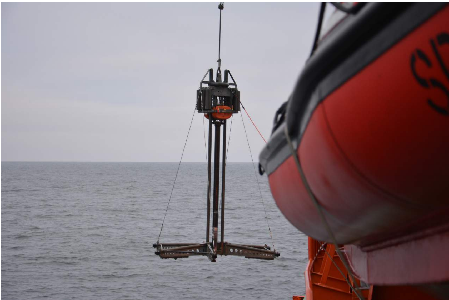
Вибропробоотбор образцов донного грунта МОРЕ ЛАПТЕВЫХ
