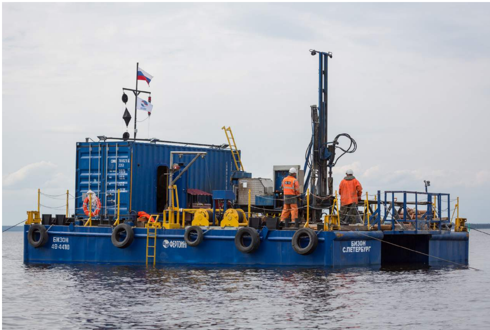
Выполнение геологических изысканий с несамоходного понтона «Бизон» БАЛТИЙСКОЕ МОРЕ
